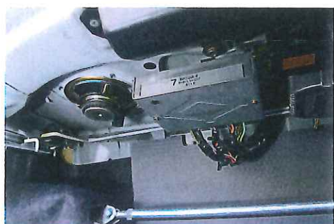
主電源となるバッテリーから一番遠くにあるABSとE-TSユニット。バッテリーが弱れば、電気が供給されずランプが点く可能性もある
