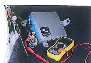
キーシリンダー、バッテリーまでの配線以外にコンピュータの配線も傷みやすい。エンジン同様にサーキットテスターを繋ぎ、カプラー内端子を点検
