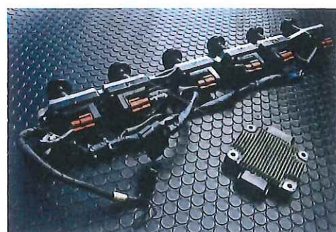
配線類を一度も交換していないければ、第2世代Rは14年以上使っていることに。電気が通ること炭化が始まり、徐々に性能が落ちる
