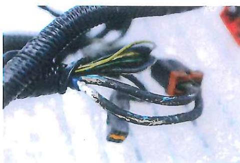
バッテリー上がりを起こした本誌R32VスベII号でオルタネーターからヒューズボックスの配線を修理。純正部品の製廃もネック
